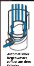
Automatischer Regenwasserzfluss aus dem Fallrohr
