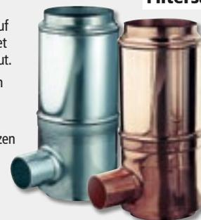
Der **Filtersammler** sammelt das Regenwasser und filtert es gleichzeitig. Durch die feine Maschenweite von 0,3 mm wird das Regenwasser sorgfältig von Verunreinigungen gesäubert, bevor es in das Regenfass gelangt. Das Filtersieb aus Edelstahl ist besonders einfach zu reinigen. Mit Anschluss für HT-Rohre DN 50 sowie 3/4-Zoll-Schlauchanschluss, 30 cm langem 3/4-Zoll-Verbindungsschlauch und 3/4-Zoll-Fassanschluss. Passend für alle Fallrohre DN 100. In 2 hochwertigen Ausführungen.
