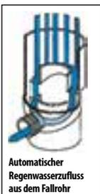
Automatischer Regenwasserzufluss aus dem Fallrohr
