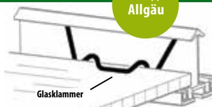
Aus Edelstahl zum Befestigen von Glasklammern und Stegdoppelplatten bis 6 mm Stärke in Beckmann-Gewächshaus- und Anlehnhäusern Typ Allgäu. 25er-Packung.
